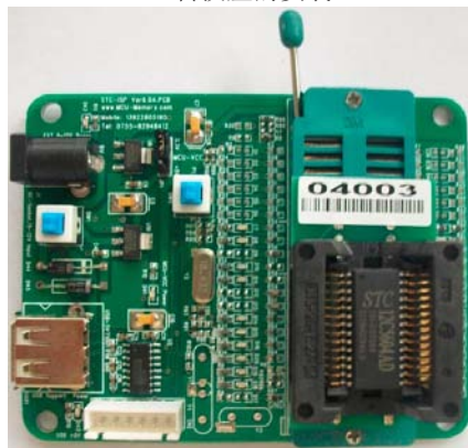
SOP-28转换座的安装
